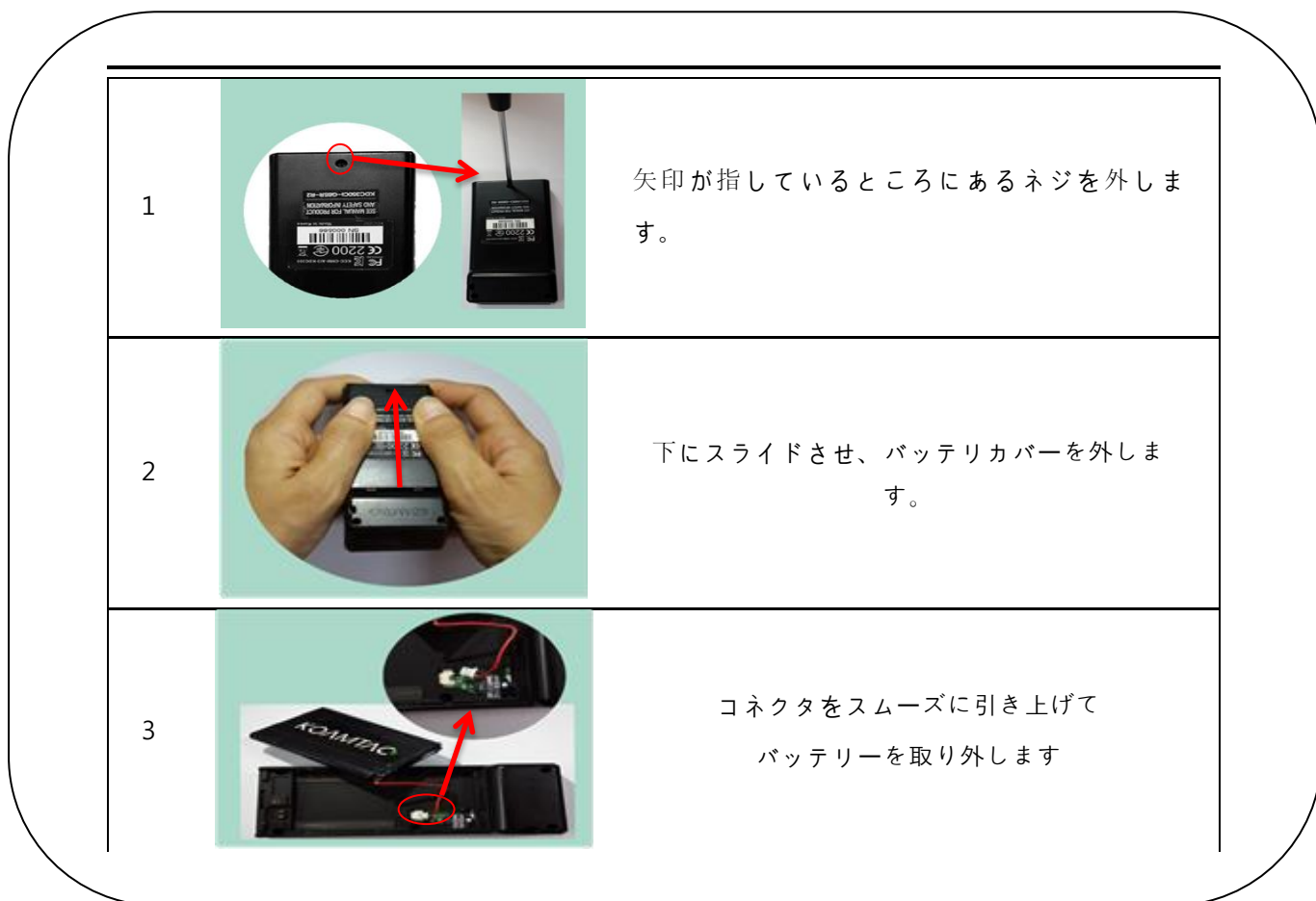
図 18-KDC 電池を交換する
